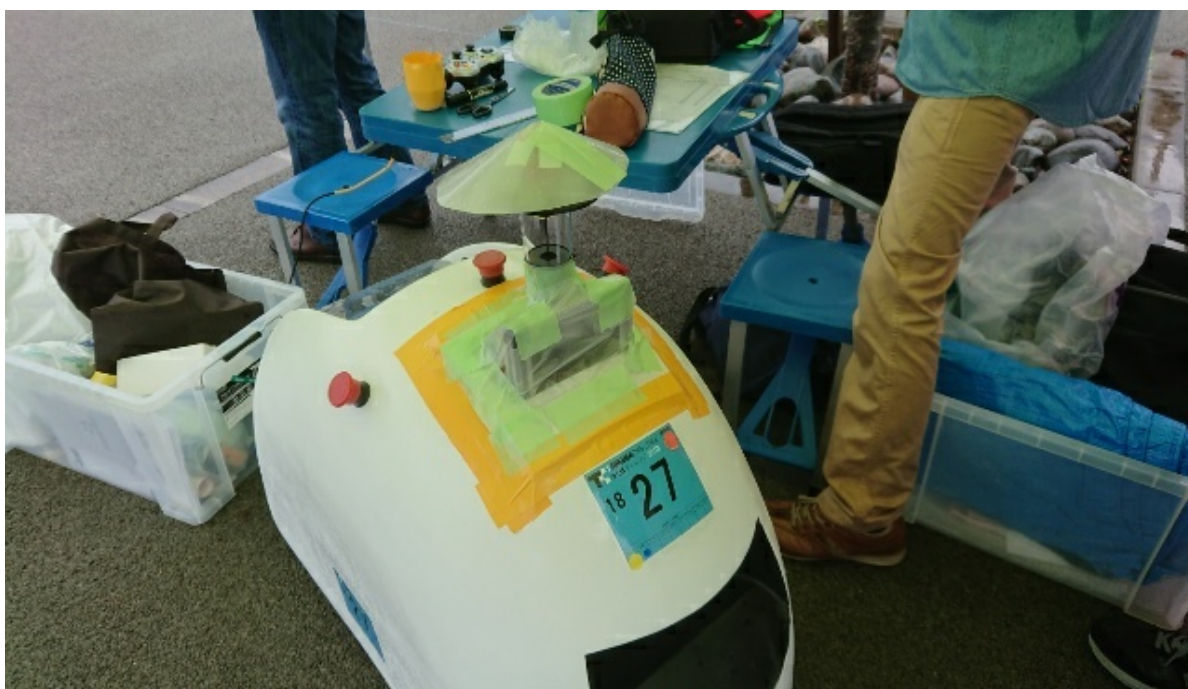
防水対策用にオムニカメラの上に設置した傘
