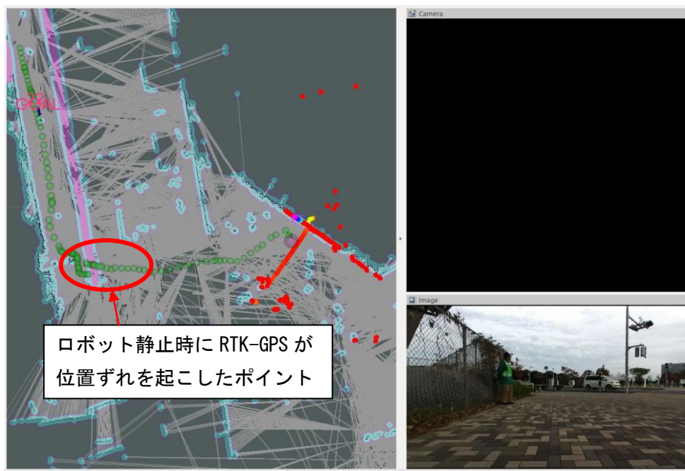
図2 高架橋の下で RTK-GPS が位置ずれを起こしている様子
